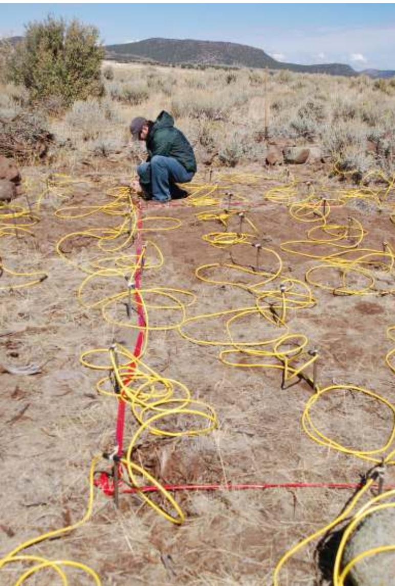
O método Elétrico de Imageamento Geofísico, é o estado da arte em termos de obtenção de informações em subsuperfície usando injeção de corrente elétrica e leitura da variação de potencial devido à resposta do solo. No método elétrico se destacam três tipos de técnicas clássicas que são a Sondagem Elétrica Vertical (SEV) o Caminhamento Elétrico (CE) e a Perfilagem Elétrica (PERF).
