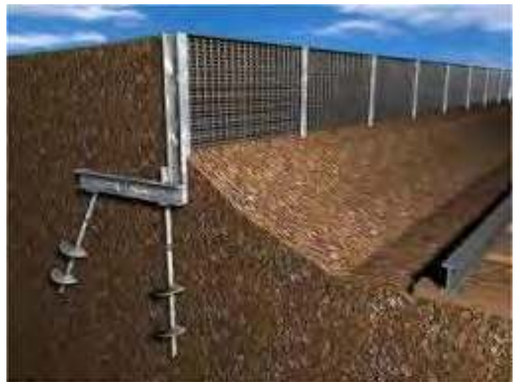
Estaca Helicoidal como sistema de fundação para muro de arrimo.
