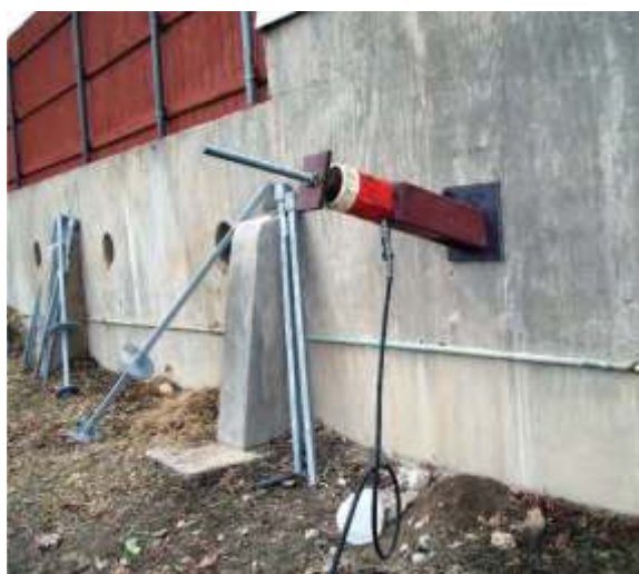
Após a instalação, as estacas são submetidas a ensaios de tração para obtenção de sua capacidade de carga.
