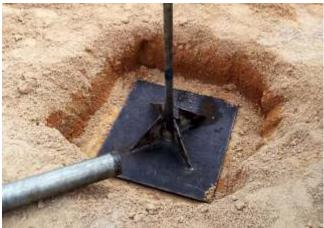
Para medir os recalques do aterro na área o projeto. Consistem em placas retangulares (50 x 50 x 2), com orifício central roscado, que enrosca tubo em PVC, com 1m de comprimento (inicial). As placas são geralmente instaladas na superfície do solo mole (base do aterro de conquista) e, à medida que o aterro é alteado, novos segmentos de tubos, com 1m, são conectados ao primeiro.
