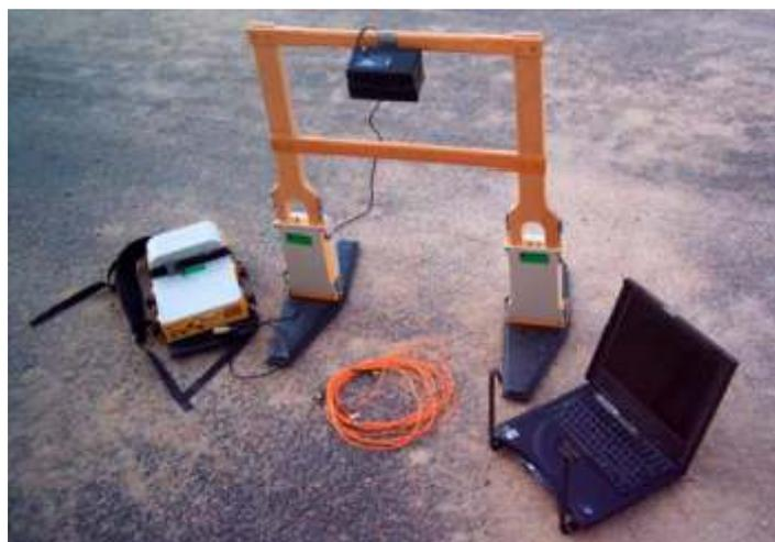
Montagem com antena de 200MHz.
