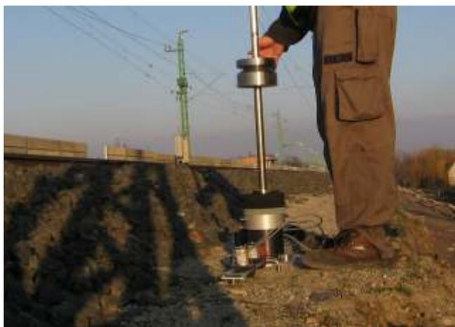
No controle da compactação e capacidade suporte do solo utilizamos o deflectômetro, dispositivo eletrônico de controle e medição usado para medir o quanto um determinado objeto ou material se desloca quando é submetido a uma carga.
